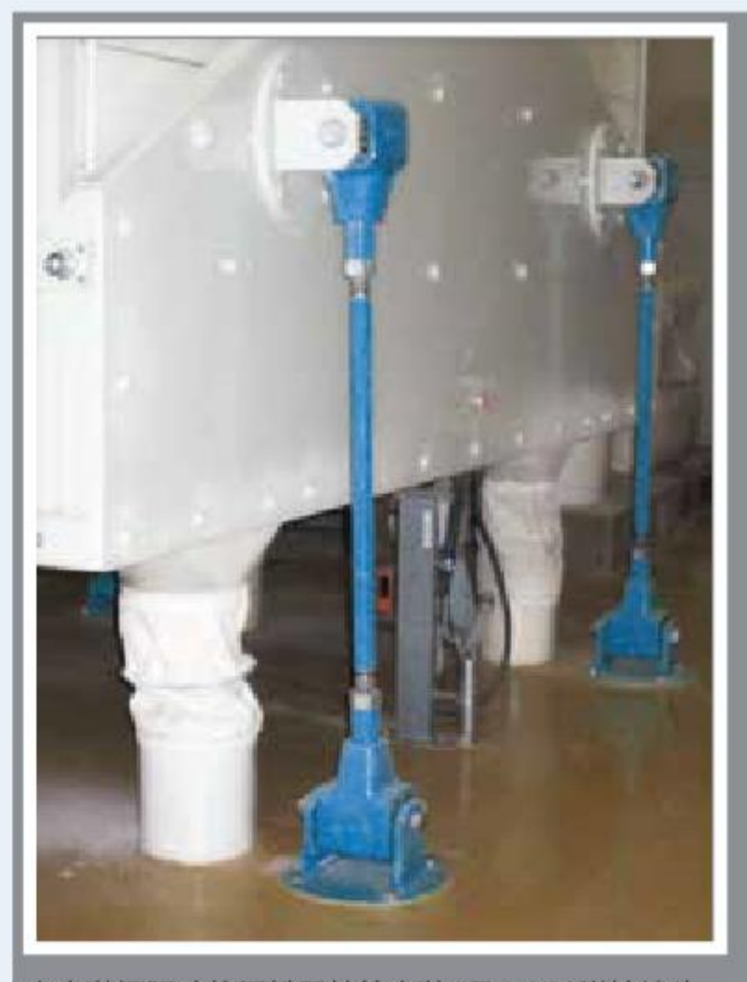
自由激振驱动的面粉回转筛安装8只AV 38弹性接头
