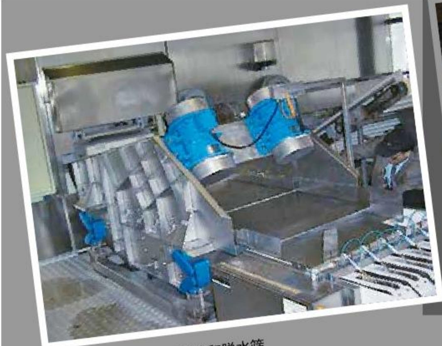
AB-D 型支撑用于硫化干燥床
