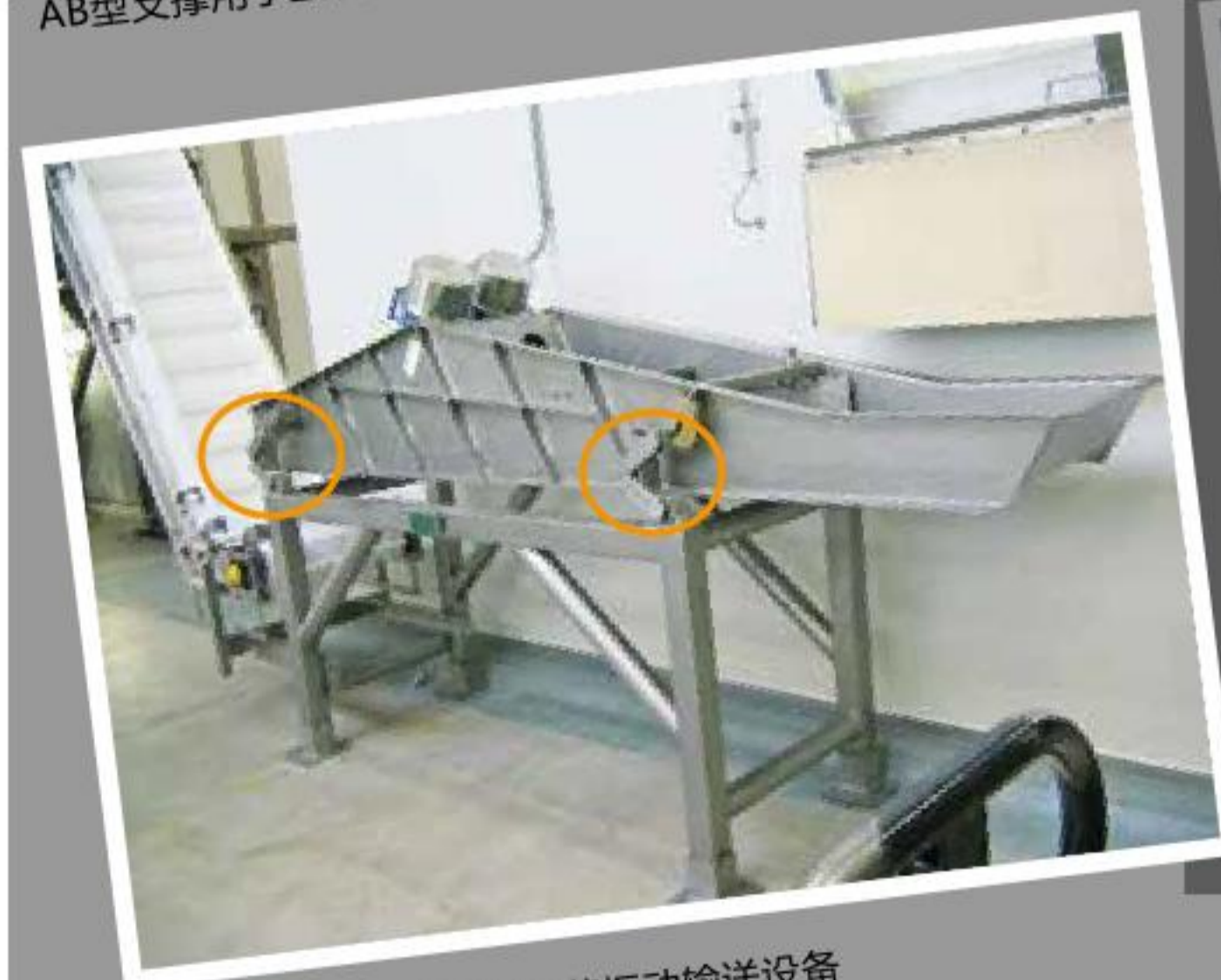
AB型支撑用于宝石的初选筛
